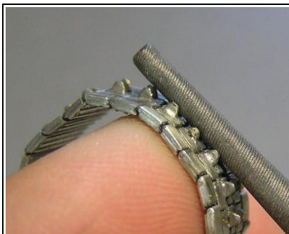
Abb.58: Die Zapfenspitzen innen entgraten. Die Laufrollen sollen dadurch leicht in den Zwischenraum gleiten.
