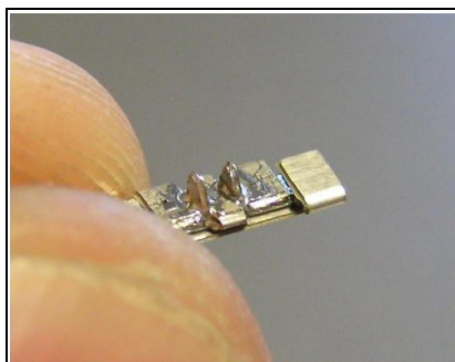
Abb.37: Beide Aussparungen sind verlötet. Die Nuten der hochstehenden halb runden Laschen sind gefüllt.
