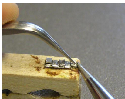
Abb.39: Auf Holzunterlage beide Stirnseiten verlöten.
