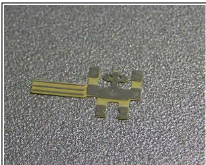
Abb.15: Alle Kettenglieder auslösen und Haltestreben abschneiden.
