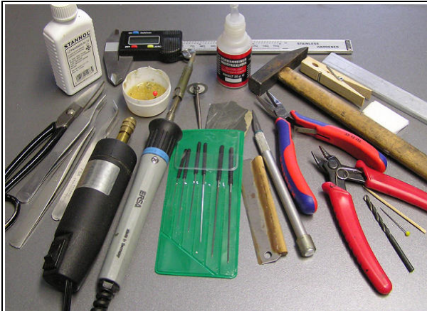
Abb.1: Werkzeuge : Schere, Pinzetten, Minibohrmaschine, Schleif- bzw. Trennscheiben, Lötkolben, Flussmittel bzw. Löt fett, Sekundenkleber, konische Reibahlen 0,5 und 1,5mm, Stecknadel, Zahnstocher, Holzklammer, Bohrer zum entgraten, Skalpell, Messschieber, Flachzange, Schleifpapier (1000er), Aluminiumprofil, stumpf geschliffene Messerklinge, Hammer
