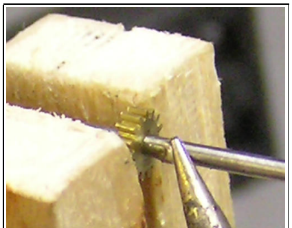
Abb.32: Die Lötstelle mit dem LötKolben so lange erhitzen, dass das Zahnrad heiß genug wird um die Welle mit der Lötstelle in das Zahnrad ziehen zu können.
