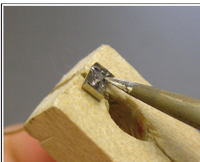
Abb.19: Den Draht nur von Innen verlöten.
