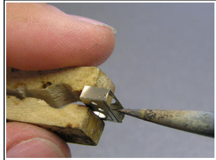
Abb.11: Mit Hilfe einer Holzklammer und einer schmalen Lötspitze die Kanten zusammenlöten.
