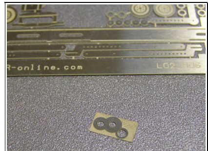
Abb.44: Getriebedeckel aus dem Ätzblech auslösen.
