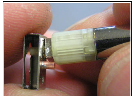
Abb.41: Um den Motor platzieren zu können muss die Buchse nun entsprechend gekürzt werden.
