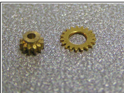
Abb.28: Das Zahnrad Z12 mit Bund und Zahnrad Z19 müssen verbunden werden.
