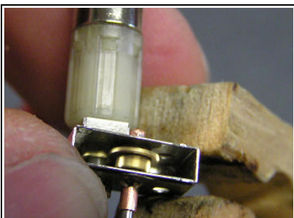
Abb.60: Motor aufstecken und nur mit den Fingern festhalten. Getriebedeckel mit einer Klammer fixieren. Probelauf mit ca. 3 Volt. Das Getriebe soll ruhig und leicht laufen.
