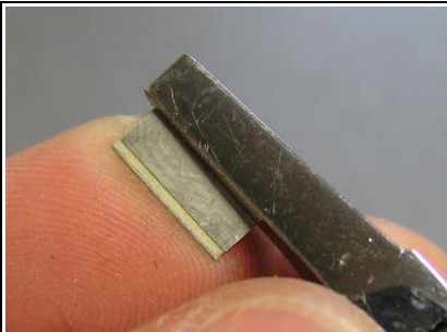
Abb.84: Die angeätzten Seiten werden um 90° aufgebogen. Der Ätzgraben ist innen. Die Flachzange weit innen am Ätzgraben ansetzen. Siehe entstehende Funktion in der Abb. 87
