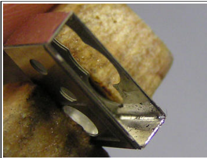
Abb.12: So soll das Ergebnis aussehen. Gut verzinnte Innenkanten.
