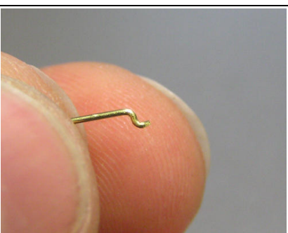
Abb.22: Für die Verbindung zwischen Servo und Lenkhebel ein 0,5mm Messingdraht wie im Bild biegen.
