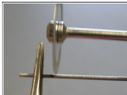
Abb.65: Die 1mm Achse mit der Trennscheibe an der Markierung entsprechend kürzen.
