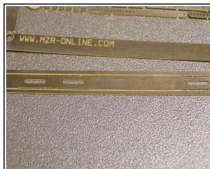
Abb.01: Das Chassis aus dem Rahmen auslösen und die Haltestege abschneiden.
