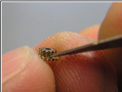
Abb.33: auch auf der anderen Seite ggf. Zinn aus den Zähnen entfernen.
